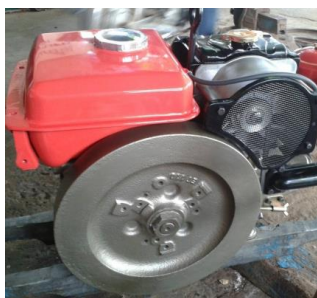
รูปที่ 2.9 ล้อช่วยแรงเครื่องสูบน้ำ
