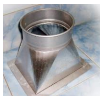
รูปที่ 2.21 การพับท่อปากเหลี่ยมลดขนาดเป็นท่อกกลม
